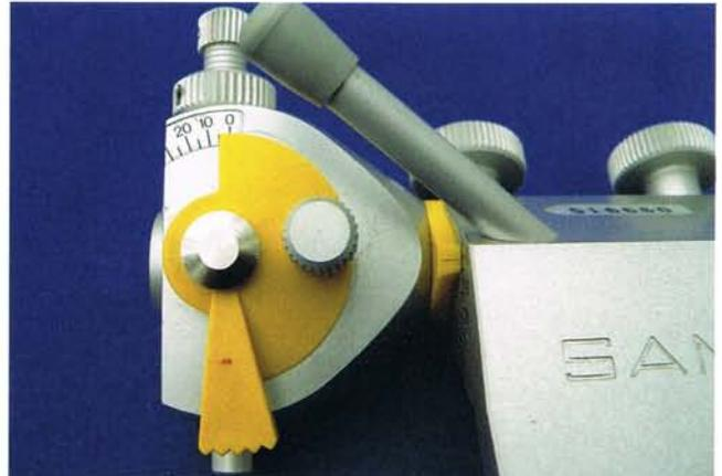
Abb. 6 Programmierung des individuellen Bennett-Winkels in einem SAM-3-Artikulator
